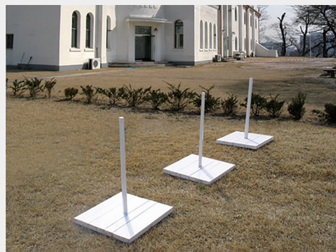
적설판 및 관측노장 설치 모습
